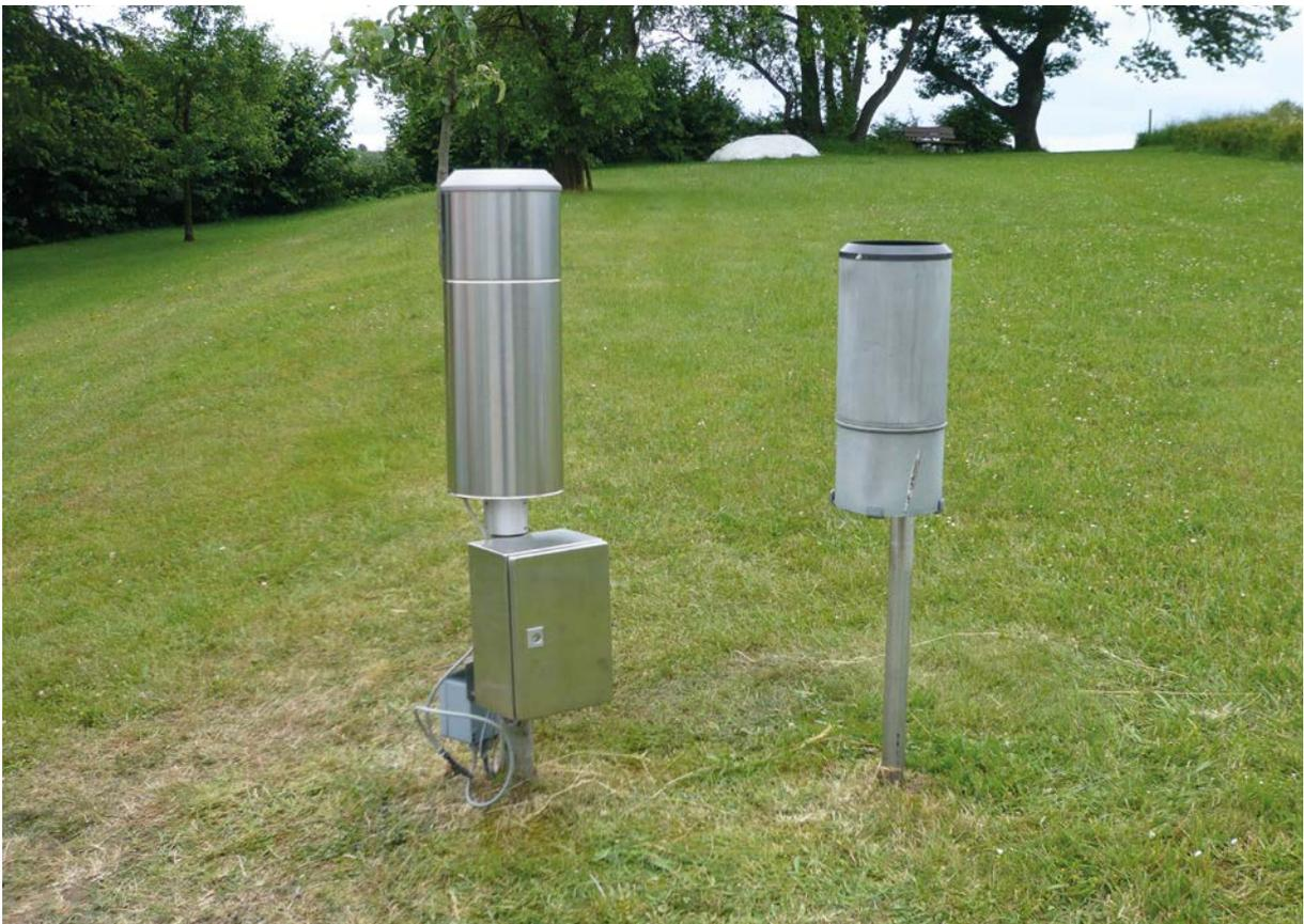
Abbildung 30: Niederschlagsmessstelle Freiensteinau: links: Pluviometer, rechts: Hellmann-Messgerät
