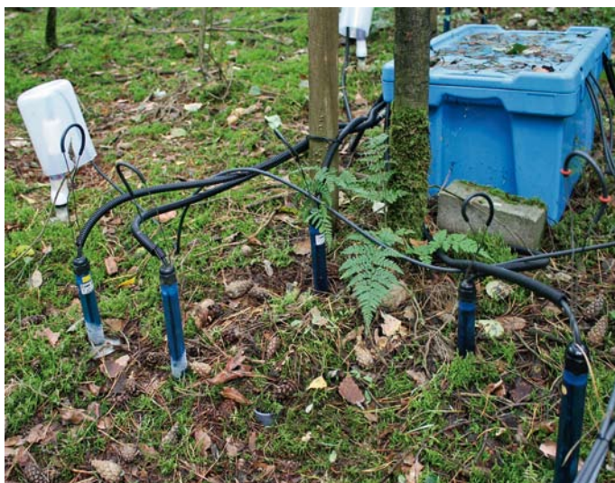
Tensiometer zur Messung der Bodenfeuchte
