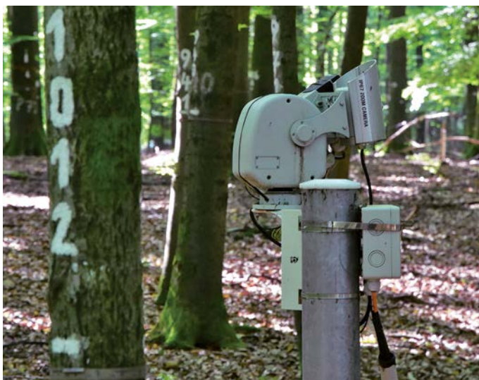
Kamera zur Erfassung der Phänologie
