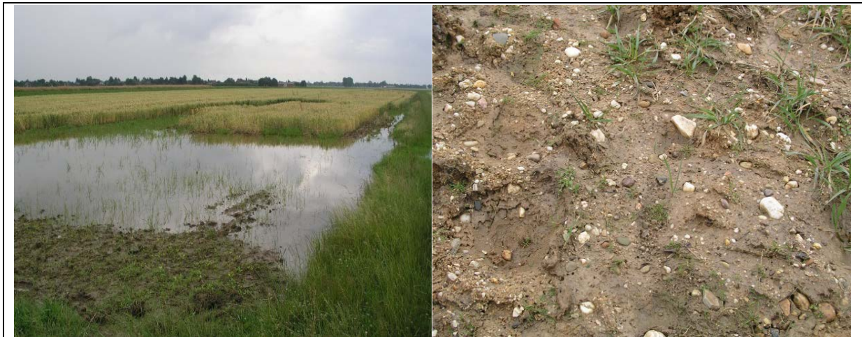
Abb. 10–1: Gefüge- und Aufwuchsschäden nach der Wiederherstellung durchwurzelbarer Bodenschichten durch schädliche Verdichtungen mit Pfützenbildungen sowie Bodenschäden durch Substratmischung, hier Kieseinmischungen in den lössbürtigen Mutterboden (Fotos: Ingenieurbüro Feldwisch)
