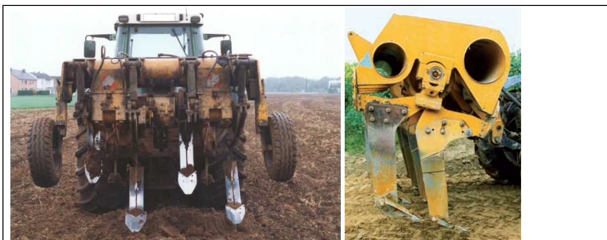
Abb. 10–2: Mechanische Tieflockerung; Links: Abbruchlockerungsgerät („MM100“) (Ingenieurbüro Feldwisch) Rechts: Stechhublockerer TLG 470 (T. Weyer, Fachhochschule Südwestfalen)
