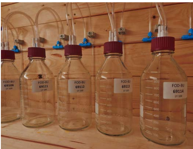
Mit Unterdruck wird Bodenlösung aus verschiedenen Bodentiefen gewonnen
