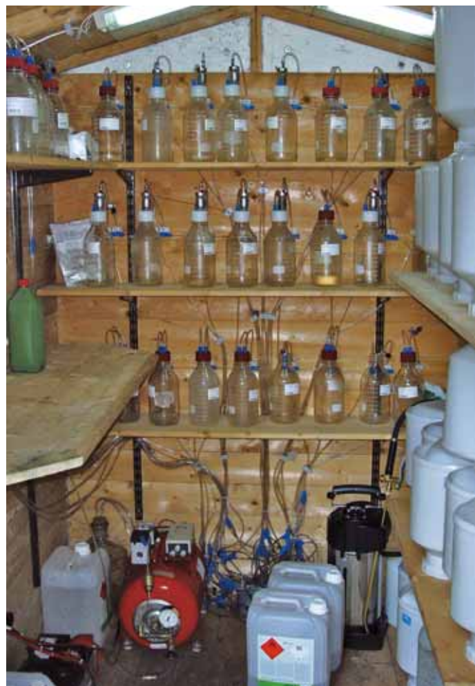
Mit Unterdruck wird Bodenlösung aus verschiedenen Bodentiefen gewonnen Foto: NW-FVA
