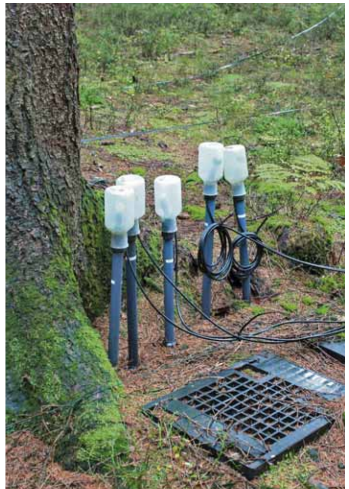
Messung der Bodenfeuchte
